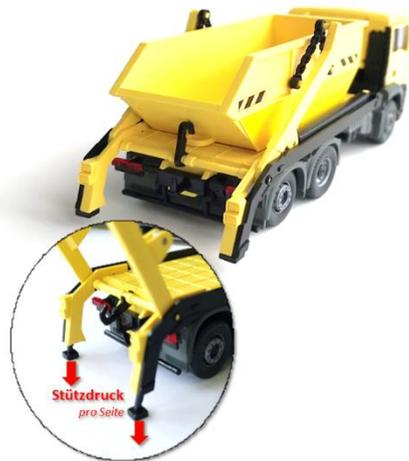
Die Kraft durch die Rollen beim Aufziehen und Absetzen auf den Boden (Rollendruck) der zwei 300 mm breiten Stahlrollen am hinteren Ende beträgt bis zu 75% des Containergewichtes (Nutzlast einschließlich Containerleergewicht)!
