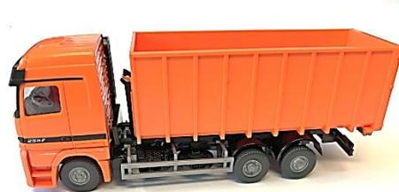
**Abrollcontainerfahrzeuge** werden auch Abrollkipper, Hakengerät oder Hakenabroller genannt. Die Fahrzeuge können nach DIN 30722 genormte Ladebehälter (sog. Abrollcontainer) transportieren.
